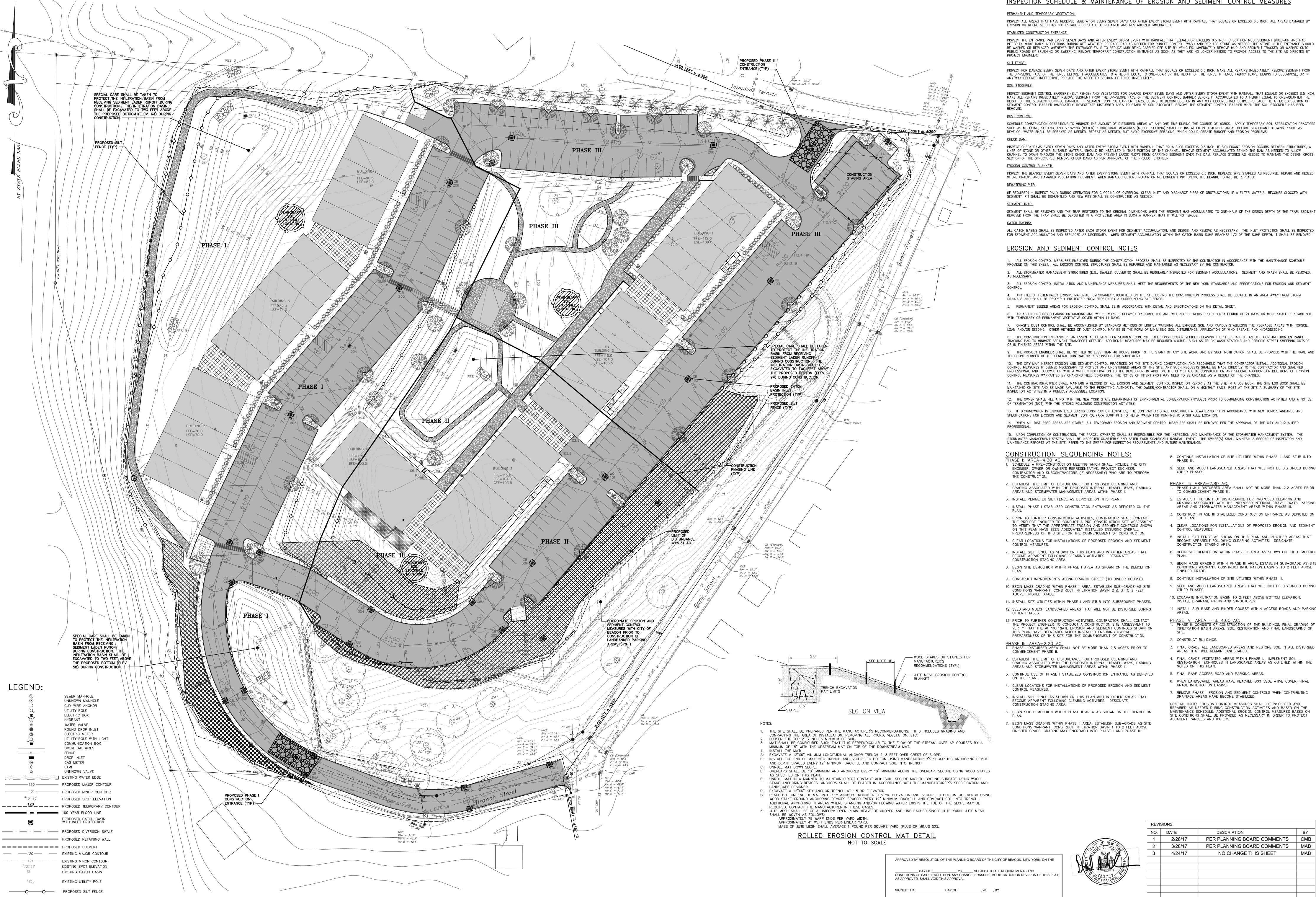
INSPECTION SCHEDULE & MAINTENANCE OF EROSION AND SEDIMENT CONTROL MEASURES
