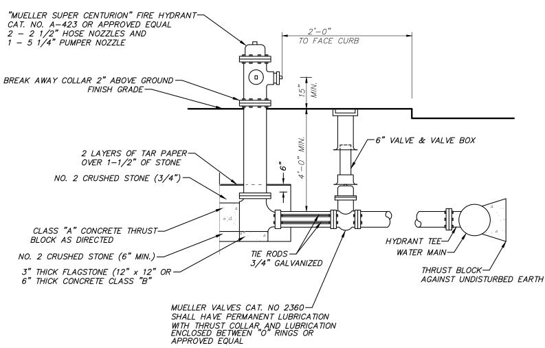
1. PUMPER OUTLET SHALL FACE STREET; 2. HOSE OUTLETS SHALL BE PARALLEL TO STREET.
