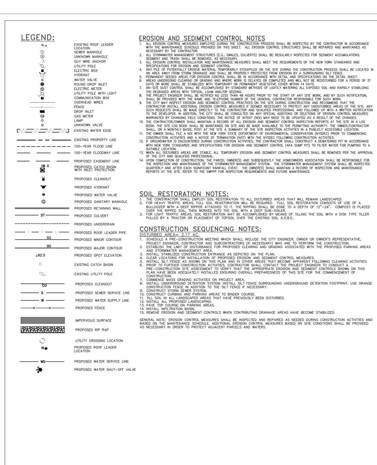
INSPECTION SCHEDULE & MAINTENANCE OF EROSION AND SEDIMENT EROSION AND SEDIMENT CONTROL NOTES . ALL EROSION CONTROL MEASURES EMPLOYED DURING THE CONSTRUCTION PROCESS SHALL BE INSPECTED BY THE CONTRACTOR IN ACCORDANCE CONTROL MEASURES WITH THE MAINTENANCE SCHEDULE PROVIDED ON THIS SHEET. ALL EROSION CONTROL STRUCTURES SHALL BE REPAIRED AND MAINTAINED AS
