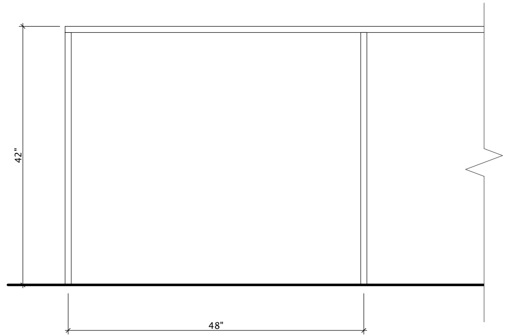
D1 SITE RAILING ELEVATION SCALE: 3/4" = 1'-0"
