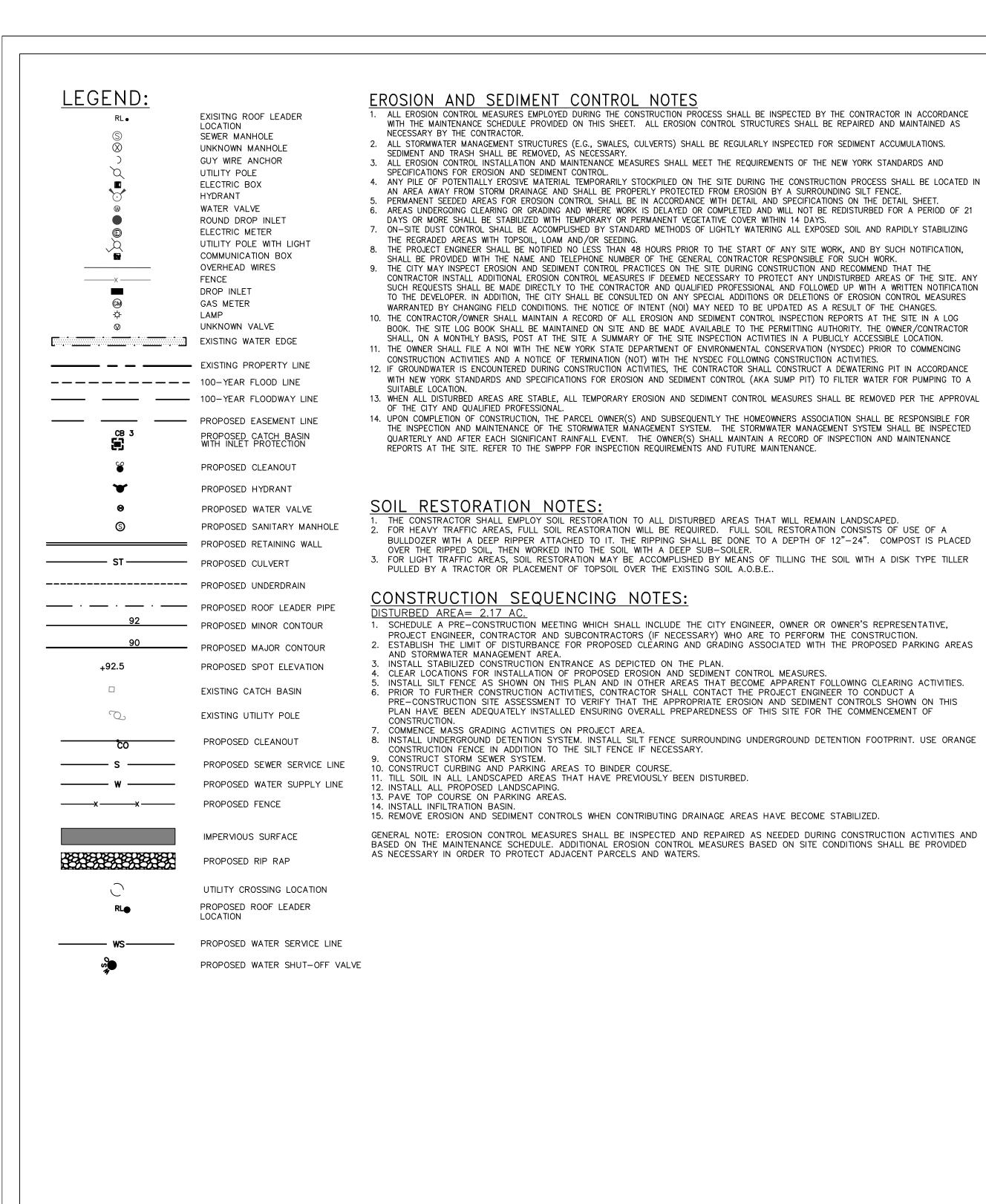
EROSION AND SEDIMENT CONTROL NOTES INSPECTION SCHEDULE & MAINTENANCE OF EROSION AND SEDIMENT CONTROL MEASURES ALL EROSION CONTROL MEASURES EMPLOYED DURING THE CONSTRUCTION PROCESS SHALL BE INSPECTED BY THE CONTRACTOR IN ACCORDANCE WITH THE MAINTENANCE SCHEDULE PROVIDED ON THIS SHEET. ALL EROSION CONTROL STRUCTURES SHALL BE REPAIRED AND MAINTAINED AS
